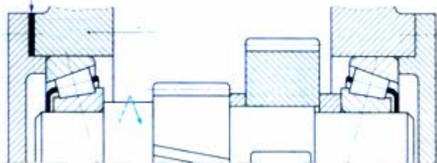
Hình 12.18: Phương pháp II, sơ đồ A (kiểu chữ O), dùng ổ đĩa côn đỡ chặn
