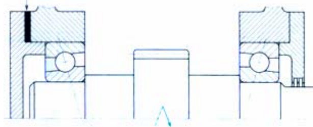
Hình 12.17 : Phương pháp II, sơ đồ A (kiểu chữ O), dùng ổ bi đỡ chặn
