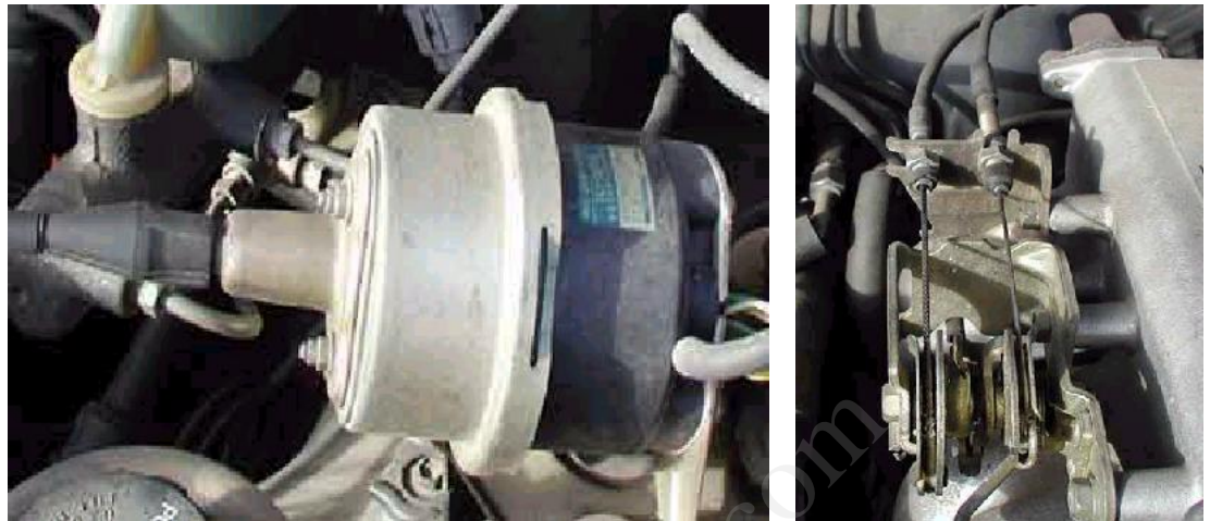
Hình 7.10: Bộ dẫn động bằng chân không
