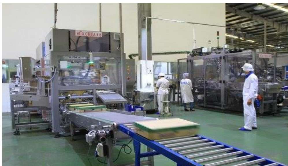
Hình1.8 Hệ thống tự động hóa đóng gói bao bì trong nhà máy sản xuất sản phẩm từ sữa
