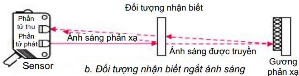
Hình 2.30 Cảm biến quang có gương phản xạ
