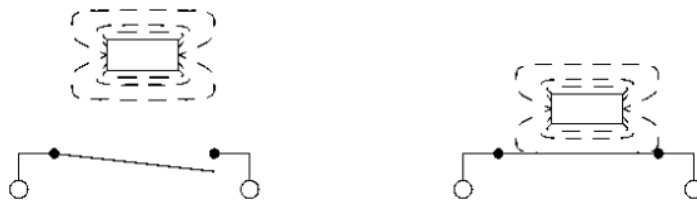
Hình 2.19 Công tắc từ
