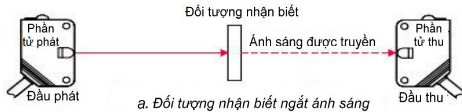
Hình 2.29 Cảm biến thu phát độc lập
