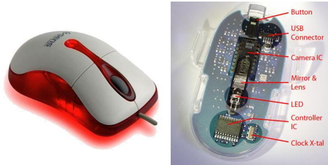
Hình 90 Chuột quang và cấu tạo
