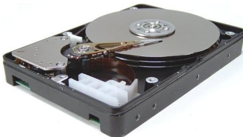
Hình 52 Ổ đĩa cứng kích thước 3,5 inches
