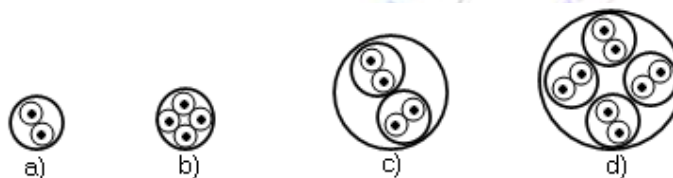
Hình 2.4: Mặt cắt của các kiểu xoắn dây cơ bản trong cáp
